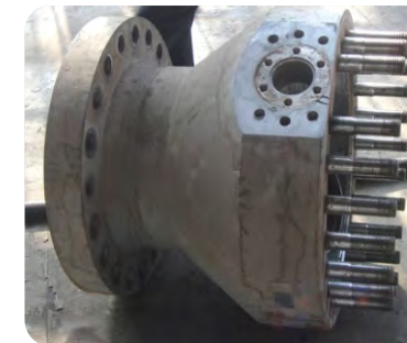
齐鲁二化锁渣阀维修
