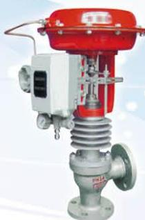
HAV / KHAV 气动 / 电动文丘里角型单座调节阀阀芯采用上导向结构，阀结构紧凑，压降损失小，流量大，可调范围广。适用于控制含有颗粒的流体和泥浆、粘性或闪蒸流体。调节阀的泄漏量符合 ANSI B16.104 标准。调节阀配用多弹簧薄膜执行机构，其结构紧凑，输出力大。
