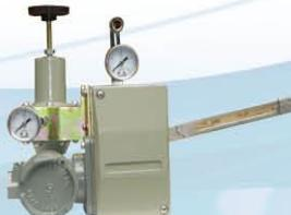
HEP<sub>3</sub>-15 / 16 / 17 单作用电气阀门定位器采用力平衡原理，把调节器输出的电信号转换为驱动调节阀的气信号，保证调节阀按调节器的输出信号迅速、准确定位，提高调节阀的控制精度，增大调节阀的允许压差。
