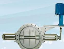
N D L W 型电子式调节蝶阀是3 8 1 0 R 和3 8 1 0 L 电子式电动执行机构和蝶阀调节机构组成，执行机构内有伺服系统，无须另配伺服放大器。具有结构简单，流通能力大，调节精度高等特点。适用于含有悬浮颗粒的流体及浓浊、浆状的流体的调节和控制，广泛应用于化工、石油、冶金、电站等行业中。
