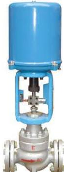
N D L N 型电子式电动双座调节阀是3 8 1 0 L型电子式电动执行机构和双座调节机构组成，电动执行机构内有伺服系统，无须另配伺服放大器，有输入信号及电源即可控制运转，连线简单，调节机构不平衡力很小，允许压差，流通能力大等特点，适用于泄漏量要求不严格的场合。
