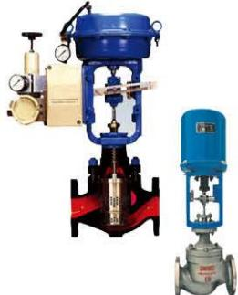
H C P / K H C P 气动 / 电动平衡笼式单座调节阀采用活塞环密封，既具有 HTS 单座调节阀的低泄漏量，又具有 HCB 平衡笼式调节阀的大压差。主要应用于泄漏低、压差大的场合。
