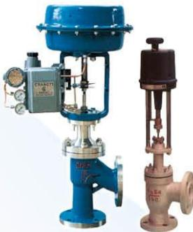
HAA / KHAA 气动 / 电动角型单座调节阀阀芯采用上导向结构，阀结构紧凑，压降损失小，流量大，可调范围广，流量特性精度高，符合 IEC 534-1-1976 标准。调节阀的泄漏量符合 ANSI B16.104 标准。调节阀配用多弹簧薄膜执行机构，其结构紧凑，输出力大。
