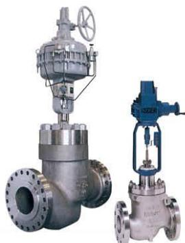
H P C / K H P C 气动 / 电动高压笼式调节阀是一种压力平衡式的调节阀，阀结构紧凑，流体通道呈 S 流线型，压降损失小，流量大，可调范围广。调节阀的泄漏量符合 A N S I B 16.104 标准。调节阀配用多弹簧薄膜执行机构，其结构紧凑，输出力大。
