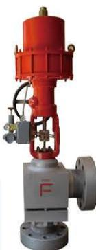
新型气动薄膜角型高压调节阀是原 ZMBS 气动薄膜型的升级换代产品，采用下阀体和透镜式阀座结构，阀座易于更换，密封性能好，阀内组件采用笼式结构，降压效果好。芯座堆焊硬质合金，耐气蚀，抗冲刷、寿命长，新型气动薄膜角型高压调节阀以其卓越品质广泛用于化工、炼油、尤其适用于合成氨尿素工业上高压和高压差调节。
