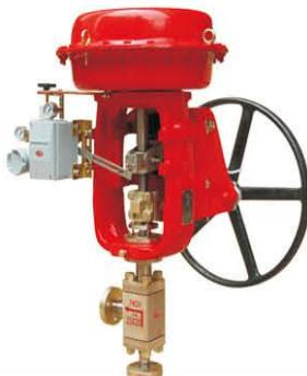
HTP 新型高压 P4 调节阀是我厂集多年生产制造 P4 阀经验，并在消化吸收引进大化肥装置先进技术的基础上研制开发具有自主知识产权的专利产品，专利号：ZL 02221208.6。控制装置采用日本技术生产的超精小型气动执行机构，阀内件采用笼式双导向结构，整个阀体密封面采用 R 球面密封。经国内众多中、小型化肥厂使用，HTP 新型高压调节阀与原 ZMBS-220/320 高压 P4 阀比较更具有抗振性能好、噪音低、耐冲刷、抗腐蚀、高压差、寿命长、使用可靠、维修方便等多项优点。
