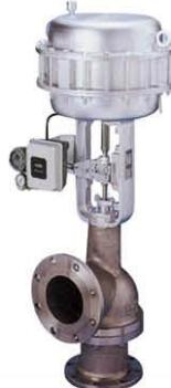
HAC / KHAC 气动 / 电动笼式角型调节阀可控制各种高、低温的高压流体，是一种压力平衡式的调节阀。阀结构紧凑，设有一个改善套筒周围流体平衡流动的导流翼，使其压降损失小，流量大，可调范围广，流量特性精度高，符合 IEC 534-1-1976 标准。调节阀动态稳定性好，噪音低，空化腐蚀小。调节阀的泄漏量符合 ANSI B16.104 标准。调节阀配用多弹簧薄膜执行机构，其结构紧凑，输出力大。
