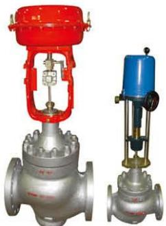
H C U / K H C U 气动 / 电动不平衡笼式调节阀阀芯采用上导向结构，阀结构紧凑，有呈 S 流线型的通道，使其压降损失小，流量大，可调范围广，流量特性精度高。调节阀的泄漏量符合 ANSI B16.104 标准。调节阀配用多弹簧薄膜执行机构，其结构紧凑，输出力大。
