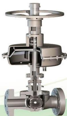
ZJHQG 上装式轨道球阀轨道球阀启闭无摩擦，解决了多数阀门因密封面之间相互摩擦而影响密封的问题。单阀座结构消除了阀门中腔介质因异常升压而影响使用安全问题。阀门靠阀杆提供的机械力，将球楔压到阀座上进行密封，使阀门的密封性能不受流向和压差变化的影响，在各种工况下密封性能都有可靠保证。该阀具有开关无摩擦、密封性能可靠、双向承压及切断、密封面抗冲刷、耐磨损能强、低扭矩操作、顶装式设计、自清洗等功能。
