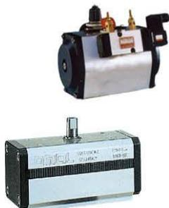
NQ G 各型气动活塞式执行机构采用齿轮齿条结构，运行平稳可靠，活塞与执行器内的滑动装置采用低摩擦材料，延长了使用寿命，单作用气缸采用预载荷弹簧座，消除了弹簧复位及执行机构安装不好而导致的危险。
