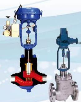
H P S / K H P S 气动 / 电动高压单座调节阀是一种上导向结构的调节阀，阀结构紧凑，压降损失小，流量大，可调范围广，阀芯导向部分的导向面积大，抗振性好。调节阀的泄漏量符合 ANSI B16.104 标准。调节阀配用多弹簧薄膜执行机构，其结构紧凑，输出力大。
