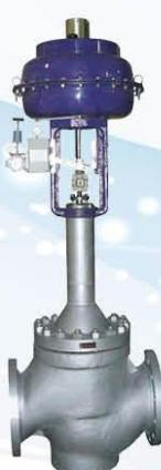
T C B / K T C B 气动 / 电动笼式调节阀是一种改进型压力平衡式调节阀，该阀套筒上装有高性能的密封环，有效的提高了泄露等级，阀体流体通道呈 S 流线型，还设有一个改善套筒周围流体平稳流动的导流翼，优点是压降损失小，流量大、可调范围广，流量特性曲线精度高，动态稳定性好，噪音低，空化腐蚀小。调节阀配多用弹簧式薄膜执行机构，结构紧凑，输出力大。
