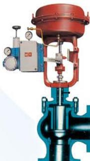
H P A C / K H P A C 气动 / 电动高压笼式角型调节阀是一种压力平衡式的调节阀，阀结构紧凑，压降损失小，流量大，可调范围广。H P A S / K H P A S 气动 / 电动高压单座角型调节阀是一种上导向结构，阀结构紧凑，压降损失小，流量大，可调范围广。阀芯导向部分的导向面积大，抗振性好。调节阀的泄漏量符合 A N S I B 16.104 标准。调节阀配用多弹簧薄膜执行机构，其结构紧凑，输出力大。
