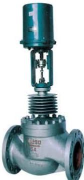
N D L M 型电子式笼式调节阀是由3 8 1 0 型电子式电动执行机构和套筒调节机构组成。电动执行机构内有伺服系统，无须另配伺服放大器，有输入信号及电源即可控制运转，连线简单，调节机构采用平衡式阀塞结构，具有阀塞稳定性好，不易产生震动，噪音低，对温度敏感性小，允许压差较大等特点，适用于流量大、泄漏量要求不严格的场合。
