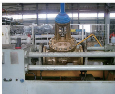
↑ 阀门试验台位 Valve Test Bench
